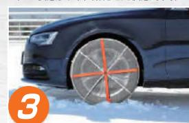
3 取り付け完了。ゴム部がタイヤの内側に完全にかぶっていることを確認してください。
