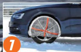
1 タイヤ(駆動輪)の接地部以外にかぶせる。
